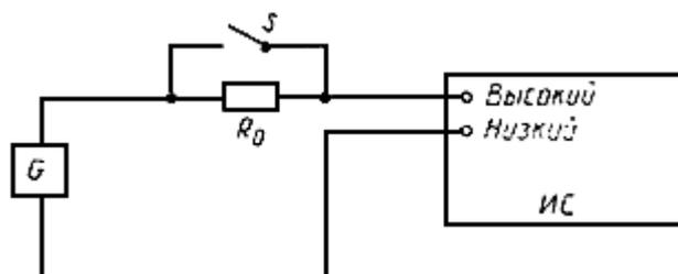
$G$  - источник переменного напряжения (переменная частота, постоянная амплитуда); ИС - испытуемый ЦИП;  $S$  - переключатель;  $R_0$  - резистор, сопротивление которого должно быть приблизительно равно 10% значения входного сопротивления ИС;
