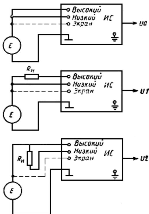
$U_0, U_1, U_2$  - аналоговые (входные) эквиваленты выходной информации;  $R_n$  - сопротивление разбаланса;  $E$  - источник сигнала помехи; ИС - испытуемое СИ;
