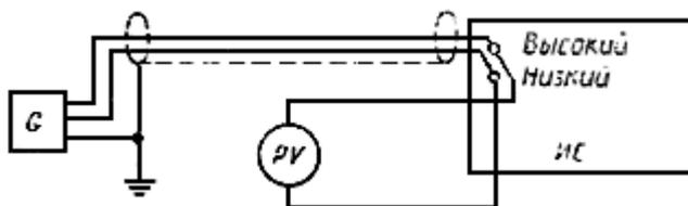
$G$  - источник переменного тока; ИС - испытуемый ЦИП;  $PV$  - вольтметр переменного тока с входным сопротивлением  $\geq 1$  МОм;
