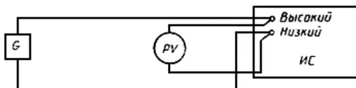
$G$  - источник постоянного тока; ИС - испытуемое СИ;  $PV$  - вольтметр постоянного тока с входным сопротивлением  $\geq 1$  МОм;
