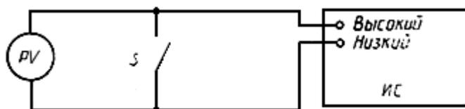
$PV$  - вольтметр постоянного тока с входным сопротивлением не менее чем в 50 раз больше конечного значения наибольшего диапазона измерений (для уменьшения ошибки, обусловленной нагрузкой);  $S$  - выключатель; ИС - испытуемый ЦИП;
