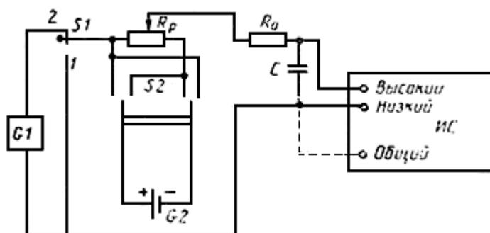
$G1$  - источник постоянного напряжения; ИС - испытуемое СИ;  $S1$ ,  $S2$  - переключатели;  $G2$  - батарея;  $R_0$  - резистор, сопротивление которого должно составлять от 10 до 50% значения входного сопротивления испытуемого СИ;  $R_p$  - потенциометр, сопротивление которого должно быть приблизительно 1/100 от  $R_0$ ;  $C$  - конденсатор, 0,1 мкФ;
