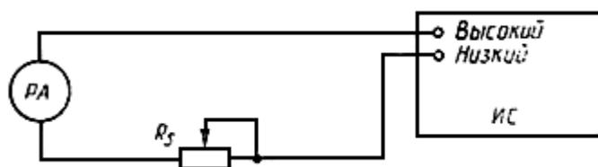
$PA$  - амперметр постоянного тока;  $R_g$  - переменное сопротивление; ИС - испытуемый ЦИП;
