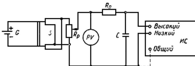
$G$  - батарея;  $PV$  - вольтметр;  $R_0$  - резистор, сопротивление которого выбирают от 1 до 100 МОм в зависимости от тока смещения;  $R_p$  - потенциометр, сопротивление которого приблизительно равно 1/100 от  $R_0$ ;  $C$  - конденсатор 1 мкФ;  $S$  - двухполюсный переключатель;
